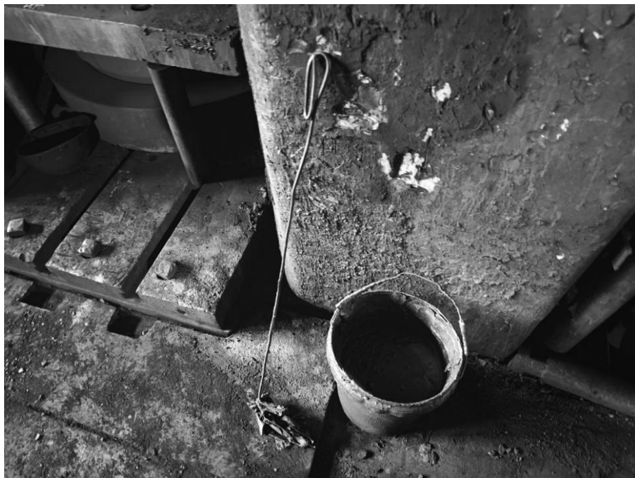
图 4 螺旋摩擦压力机右侧地面放置的脱模剂和涂抹钢钎
