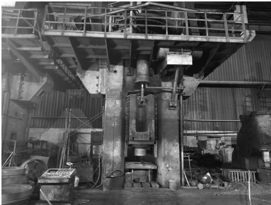
图 2 涉事双盘摩擦压力机
