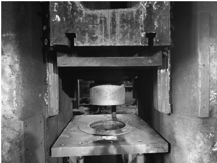
图 3 涉事双盘摩擦压力机内部工件锻打平台 (由北向南拍)
